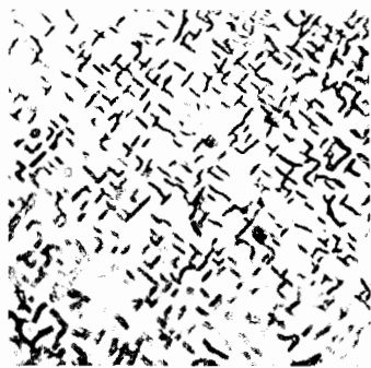
Orientierte Aufwachsung von Polyäthylen auf (001) NaCl
